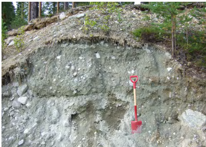
Fig. 28. Morän innehåller alla kornstorlekar och kornen är ofta skarpkantade.
