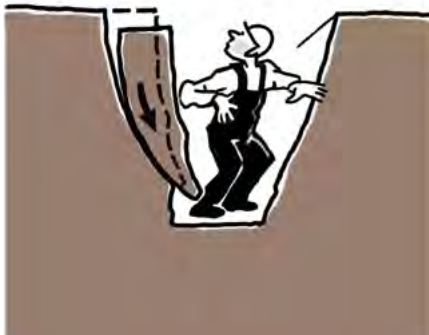
Fig. 47. Ett litet skred kan bli farligt i en smal schakt.
