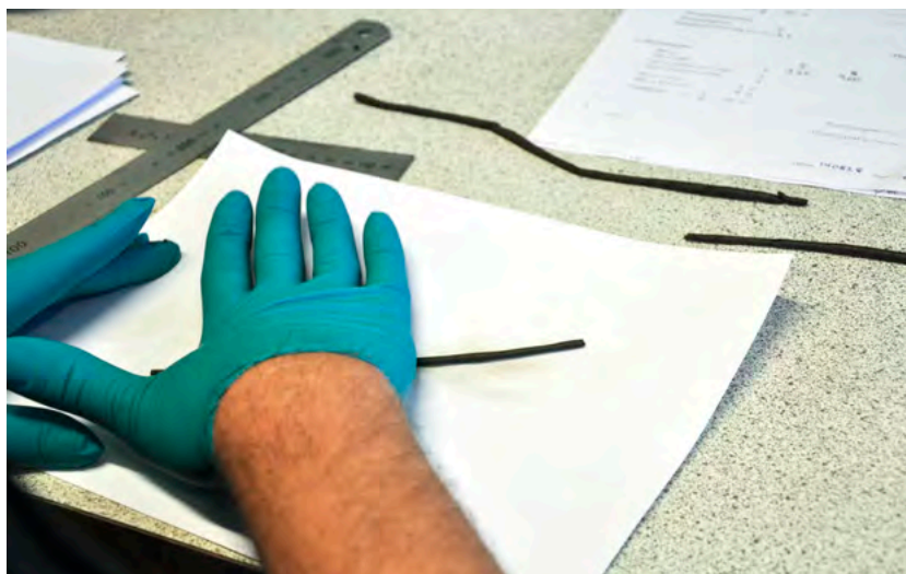
Fig. 15. Utrullningsprov på lera.
