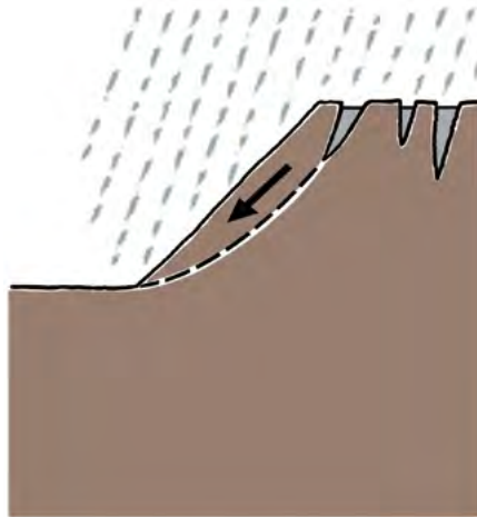
Fig. 46. Vattenfyllda sprickor försämrar stabiliteten.
