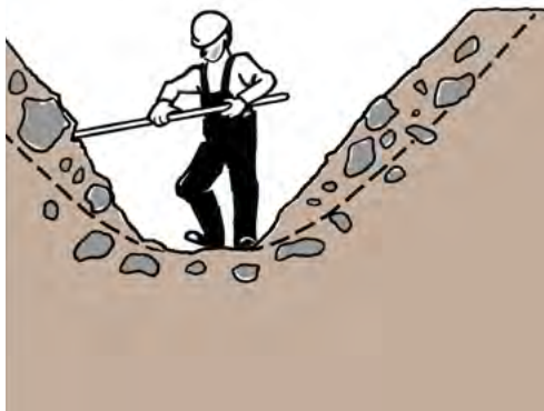
Fig. 73. Flackare släntlutning kan behövas på grund av fara för blockutfall. Blockrensning utförs lämpligast med grävmaskin
