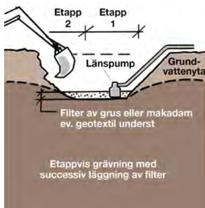
Fig. 59. Schaktning med filter i silt.
