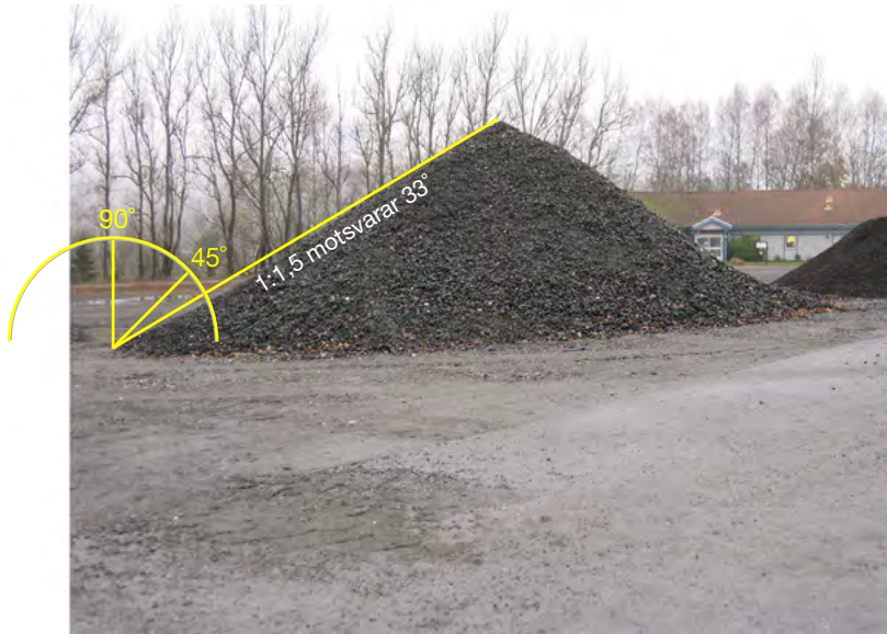
Fig. 21. Grus uppschaktat i en hög. Släntlutningen motsvarar friktionsvinkeln.
