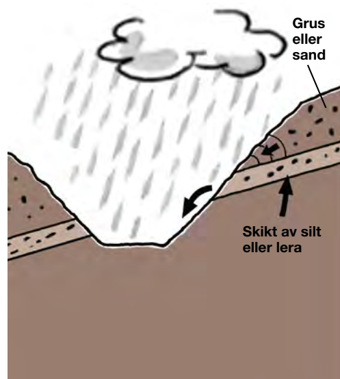
Fig. 68. Eroderande vattenströmning på skikt av silt eller lera.
