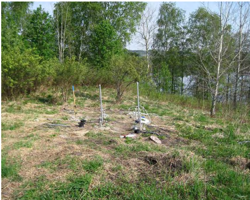
Fig. 91. Station med portrycksmätning samt exempel på filterspetsar (BAT MkIII). Foto (lilla figuren): BAT.
