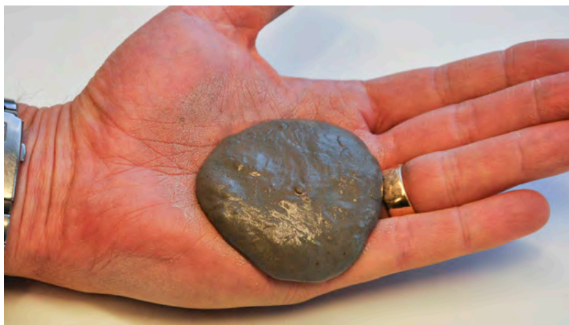
Fig. 17. Vid skakning av ett siltprov flyter provet ut och ytan blir glansig av vatten.
