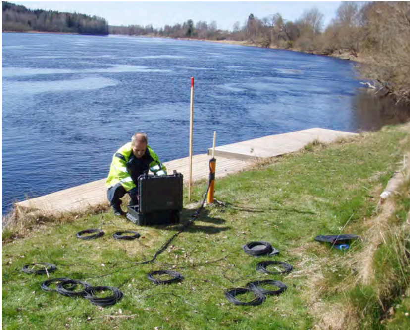
Fig. 90. Inklinometermätning med exempel på utrustning.
