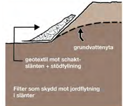
Fig. 57. Filter vid schaktslätter i silt.
