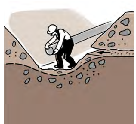
Fig. 71. Skikt i morän kan bestå av vattenförande silt eller sand som kan orsaka stabilitetsproblem.
